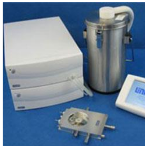
میکروترمومتری میانبارهای سیال (Fluid inclusion) شرکت سازنده Linkham :کشور انگلستان مدل : THMSG۶۰۰
