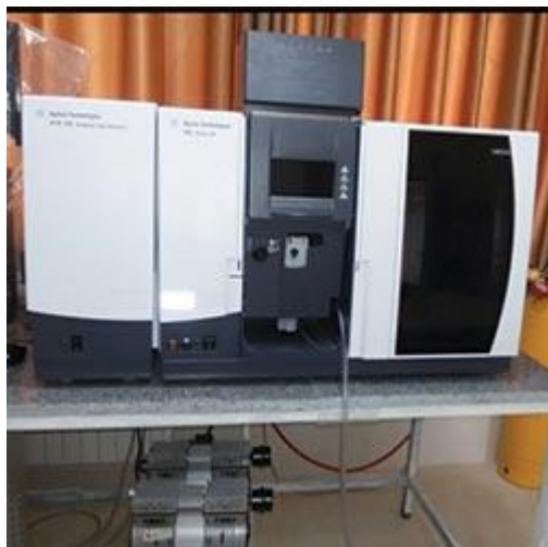
طیف سنجی جذب اتمی Atomic Absorbption شرکت سازنده Agilent :کشور آمریکا مدل: FSAA۲۴۰
